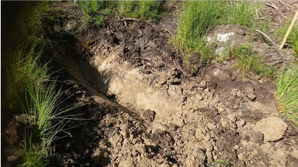
Bild 4; Provgrop 23L14 med framschaktad bergyta.
